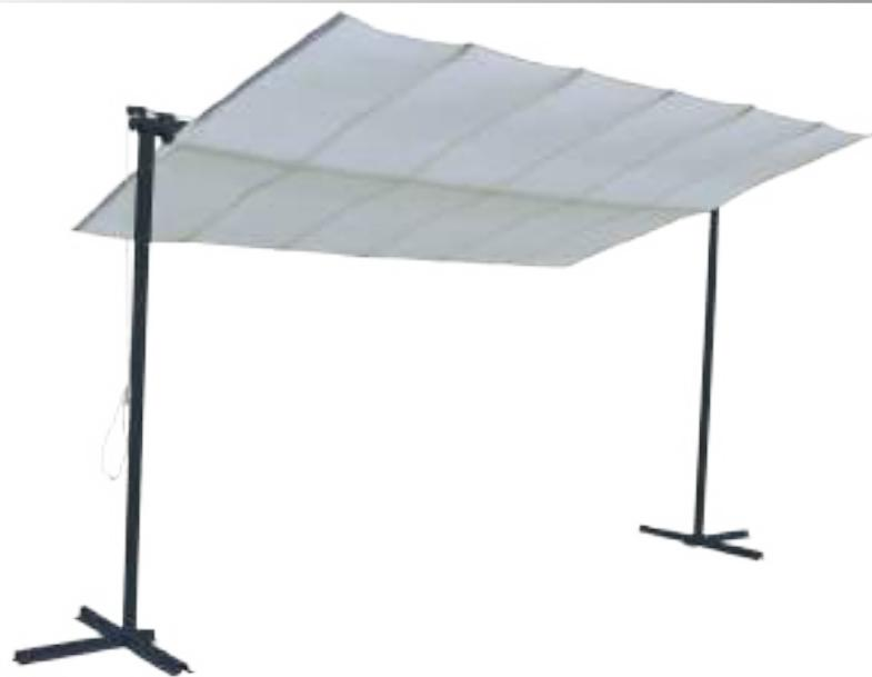
Pérgola corredera modelo Bali. Estructura de aluminio con viga central de 45x73mm. Pilares reforzados de 65mm. Cubierta orientable de poliéster de 200g/m<sup>2</sup> color crudo. Aluminio antracita.
